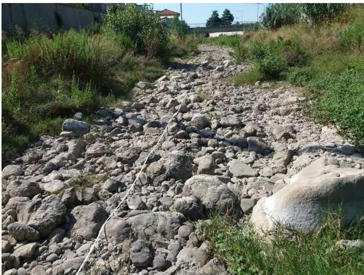
Una volta riportati i valori di “b” misurati in sito (complessivamente n. 280 misure) si è provveduto all’elaborazione di tali misure consistita in primis nell’ordinamento in ordine decrescente dei dati; si è poi suddiviso il campione in classi granulometriche sulla base della classificazione riportata dall’American Geophysical Union (adeguatamente semplificata) la quale fornisce gli intervalli di diametro per le differenti classi (massi grossi, massi medi, ciottoli
