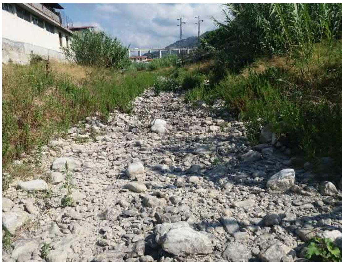
Lo stendimento n. 5, realizzato a monte del ponte della Via Romana, in corrispondenza dell'immobile magazzino/punto vendita della ditta Tasselli, ha fornito un valore minimo di diametro intermedio "b" di 21 mm ed un massimo di 285 mm (con una media di 85 mm).
